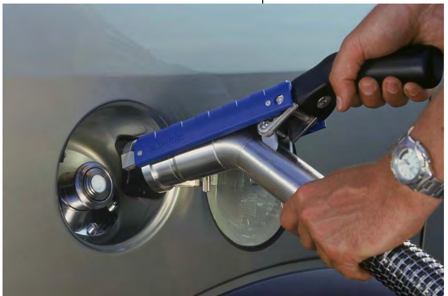
Foto 7.6. Sistema de llenado del depósito.
