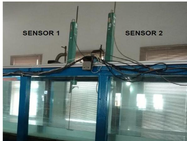
**Fotografía 2 Sensores tipo resistivo de medición de oleaje para los ensayos en modelo hidráulico en el canal de olas.**
