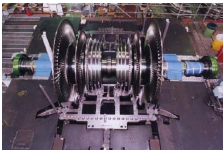
Figura 2.2.3.1 Turbina de vapor
