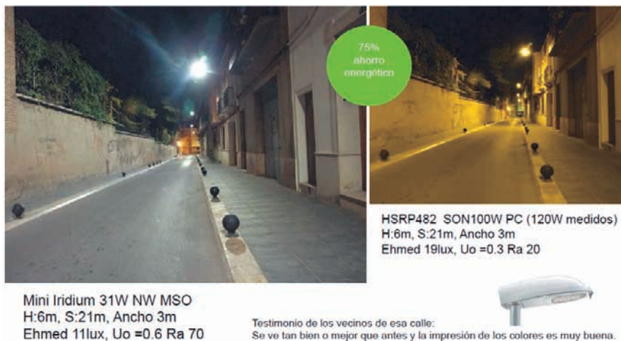
Figura 6. Ejemplo de sustitución de luminarias de VSAP por luminarias LED de menor potencia
