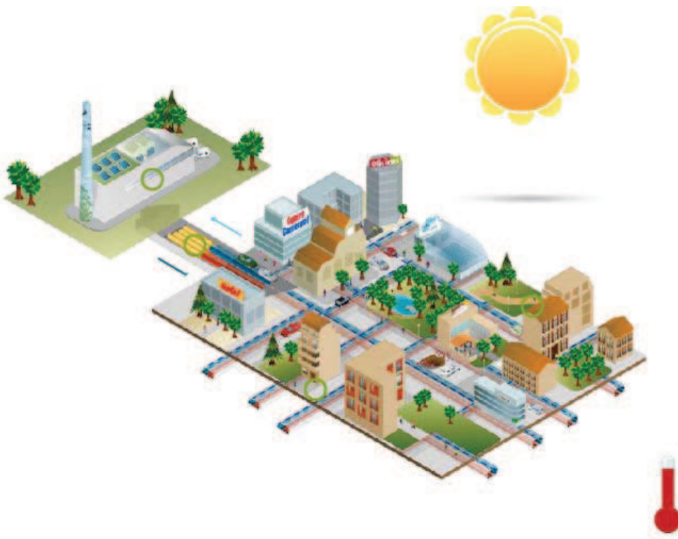
Figura 1. Esquema general red DHC.
