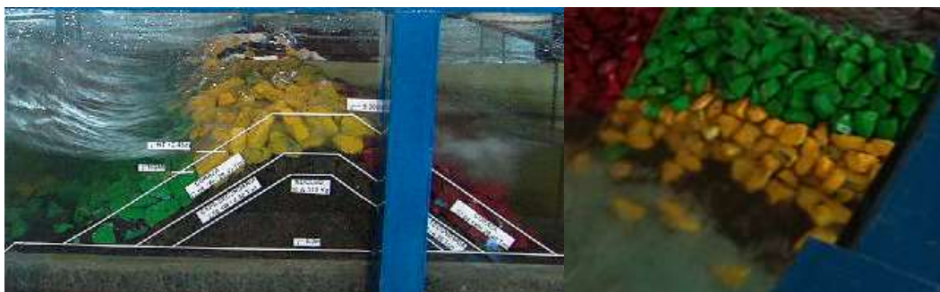
Fotografía 4. Ensayos de secciones de coronamiento abierto y cerrado construidas con coraza de roca.
