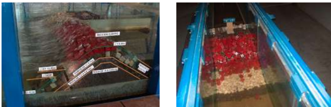
Fotografía 5. Ensayos de secciones de coronamiento abierto y cerrado construidas con coraza de cubos ranurados.
