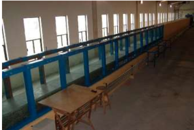
Fotografía 2. Canal de olas angosto del Laboratorio de Ingeniería de Puertos y Costas del Instituto Mexicano del Transporte.
