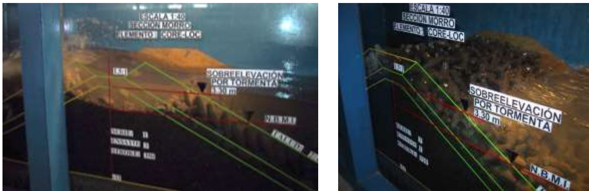
Fotografía 3. Ensayos de secciones de coronamiento abierto y cerrado construidas con coraza de core-loc.
