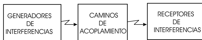
FIGURA 1.1: Partes principales de todo fenómeno de interferencia electromagnética.
