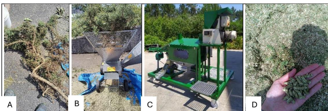
**Figura 1.** Proceso seguido para el tratamiento de biomasa forestal (en este caso Tojo- *Ulex Europaeus*) para su posterior uso en pirólisis para la obtención de biochar. De izquierda a derecha: especie Tojo (A), proceso de trituración *in situ* (B), máquina de secado y peletizado (C), pélets listos para ser usados en pirólisis (D).
